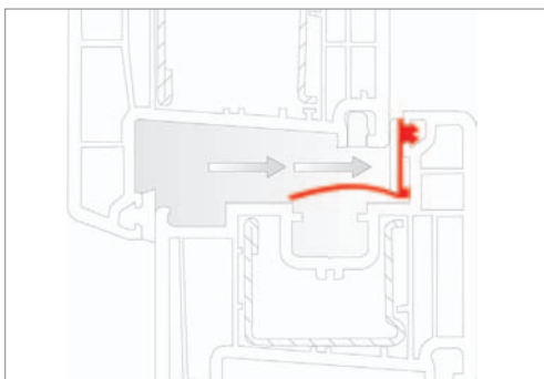
Lüfterstellung bei normalem Luftdruck
